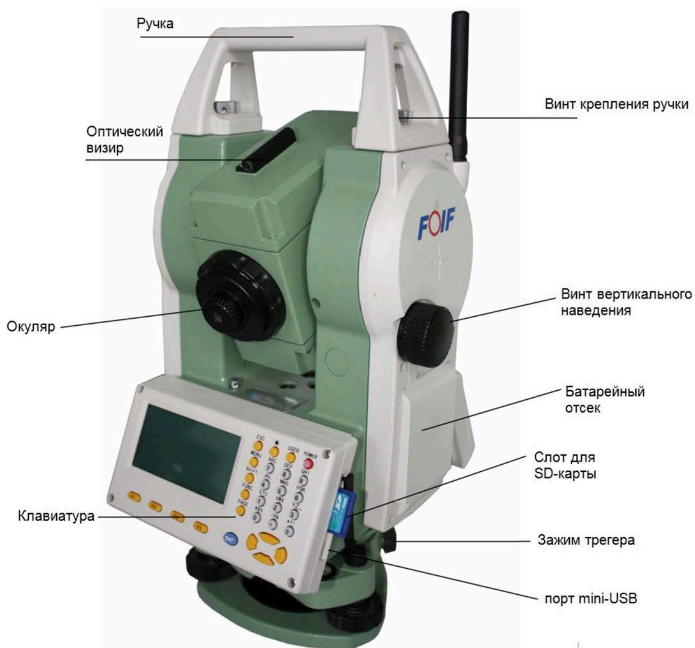
Рисунок 3 - Основные элементы тахеометра RTS332 (задняя часть)
